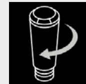
Filter in het waterreservoir vastdraaien
